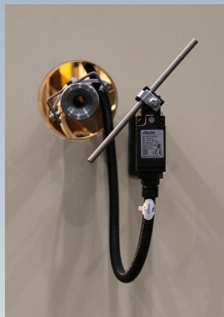
Système de contrôle des fins de barre/fil
